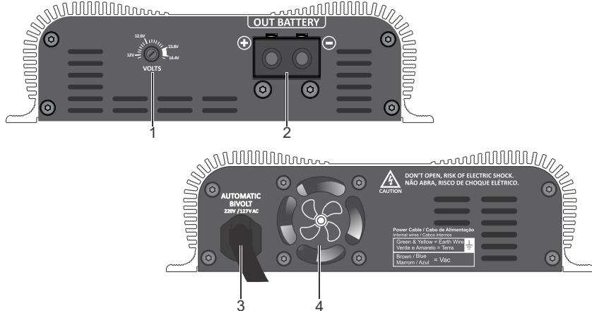
**1 - VOLTS:** Ajusta la tensión de salida entre 12V hasta 14,4V.
