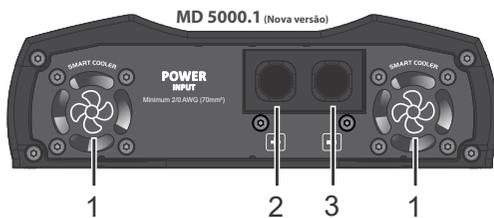
**1 - COOLERS:** Este amplificador possui dois cooler de ventilação interna. Para perfeito funcionamento, o amplificador deve ser instalado em local seco e arejado, com espaço livre de no mínimo 1" (25mm) de cada lado. A temperatura normal de trabalho deste amplificador é de 65° C.
