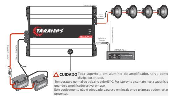
Exemplos de conexões na entrada de alimentação: Obs: Capacida de mínima requerida do banco de baterias: 280 Ah
