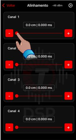
O fato das bobinas dos diferentes transdutores (alto-falantes, drivers e tweeters) não estarem alinhados, gera atrasos que prejudicam a perfeita reprodução sonora. O recurso **Alinhamento**, permite alinhar eletronicamente as bobinas, aplicando atrasos em relação à via com a bobina mais profunda (medida a partir do painel frontal da caixa).
