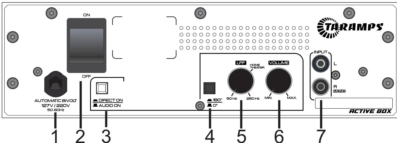
**1 - Cabo de Energia:** Conecte o cabo na rede de energia elétrica. Este produto opera com alimentação entre 90 a 240 VAC.
