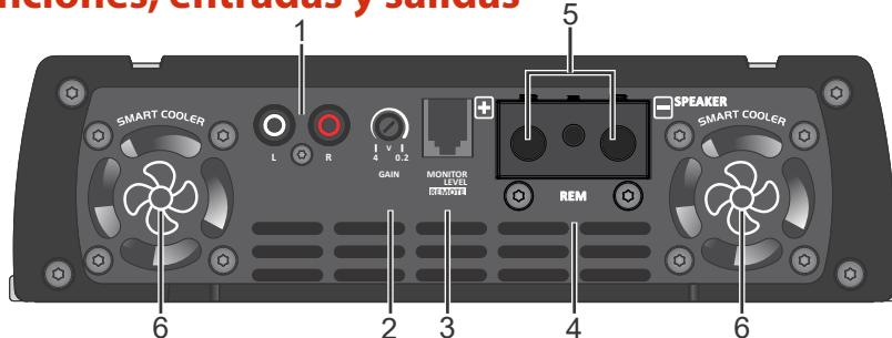
**1 - R y L:** Entradas para las señales a amplificar. Conéctelas a las salidas amplificadas (cables) del reproductor multimedia. Utilice cables blindados de buena calidad para evitar captar el ruido.
