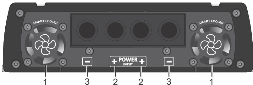
**1 - SMART COOLER:** Este amplificador tiene cuatro coolers internos de ventilación. Controlados por un sistema inteligente que sólo funciona a máxima velocidad cuando es necesario, garantizando una vida más larga del cooler y un funcionamiento más silencioso de su producto. Para un rendimiento óptimo, instale el amplificador en un lugar fresco y bien ventilado, manteniendo al menos 25 mm de espacio libre alrededor del disipador. Temperatura de operación típica: 65°C.
