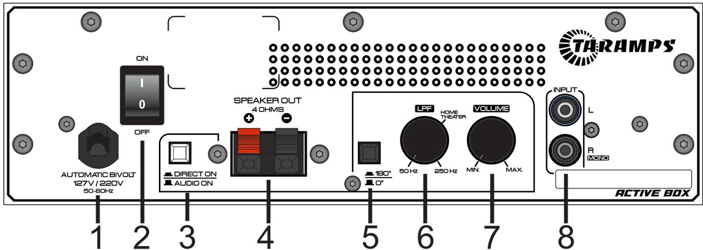
1 - **Cable de Alimentación:** Conecte el cable a la red eléctrica. Este producto funciona con una fuente de alimentación entre 90 y 240 VCA.
