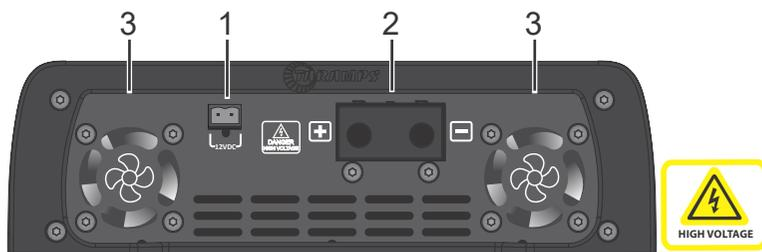
**1 - TERMINAL DE PREALIMENTACIÓN DEL AMPLIFICADOR POSITIVO 12VDC / 1.5A:** Esta alimentación debe ser proporcionada mediante una batería exclusiva y con la ayuda de un relé, activado por el control remoto del Reproductor de CD / DVD (ver esquema en la página 06).
