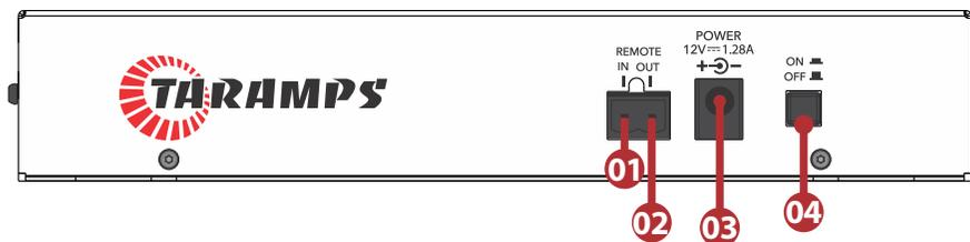
El **T 0602 MULTICOLOR** fue diseñado para ser utilizado en sistemas automotrices con batería de 12V, pero también se puede utilizar con un adaptador de enchufe externo de 12V con una corriente de al menos 2A, que debe comprarse por separado (en este caso, el consumidor debe pagar atención al enchufe del adaptador que debe ser estándar P4-2mm) . Dispone de botón ON/OFF que elimina las conexiones REMOTE IN.
