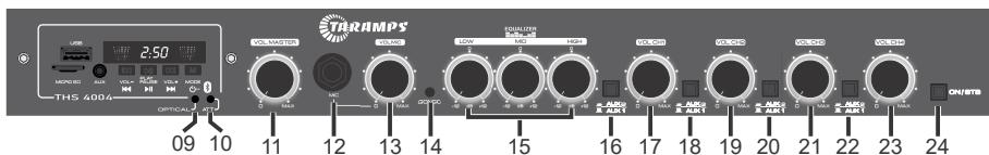
**9 – ÓPTICAL:** Entrada de áudio óptico. Para utilizar esta conexão, configure a saída de som da sua TV para "Saída Óptica". É indispensável que o formato de áudio digital esteja definido como PCM. Caso o aparelho fique sem som, acesse o menu de áudio da sua TV e confirme se a opção PCM está selecionada. Consulte o manual do fabricante se necessário.
