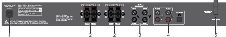
**1 - CABO DE ENERGIA:** Conecte o cabo na rede de energia elétrica. Este produto opera com alimentação de 127V AC ou 220V AC.
