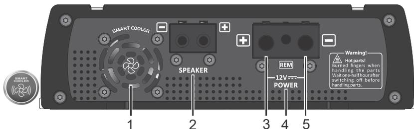
**1 - COOLER:** Este amplificador possui um cooler de ventilação interna. Para perfeito funcionamento, o amplificador deve ser instalado em local seco e arejado, com espaço livre de no mínimo 1" (25mm) de cada lado. A temperatura normal de trabalho deste amplificador é de 65°C.
