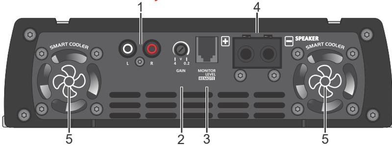
**1 - R y L:** Entradas para las señales a amplificar. Conéctelas a las salidas amplificadas (cables) del reproductor multimedia. Utilice cables blindados de buena calidad para evitar captar el ruido.
