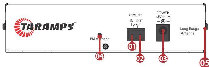
A **T 0302 PLAYER MULTICOLOR** foi desenvolvida para ser utilizada em sistemas automotivos com bateria de 12V mas também poderá ser utilizada com adaptador de tomada externo 12V com corrente de pelo menos 2A que deverá ser adquirido separadamente (neste caso o consumidor deverá ficar atento com o plug do adaptador que deverá ser padrão P4-2mm). Possui botão liga/desliga ON/OFF (painel superior) que dispensa as conexões de REMOTE IN.
