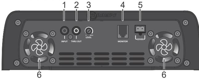
**1 - INPUT:** Conectar à saída RCA do CD / DVD Player, utilizando cabos blindados de boa qualidade para evitar a captação de ruídos. Os sinais das entradas L e R são misturados (adicionados) internamente.
