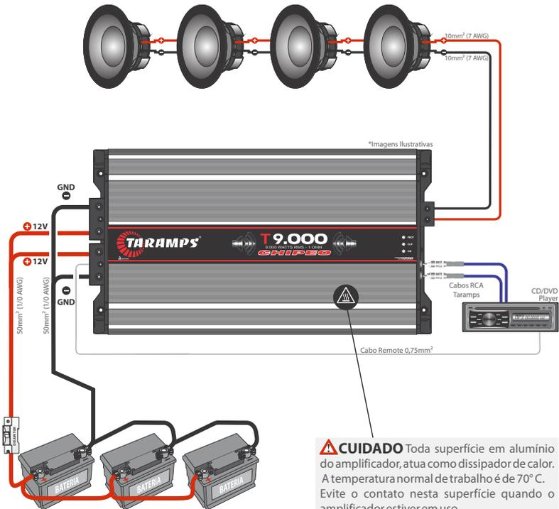
**⚠ CUIDADO** Toda superfície em alumínio do amplificador, atua como dissipador de calor. A temperatura normal de trabalho é de 70° C. Evite o contato nesta superfície quando o amplificador estiver em uso.
