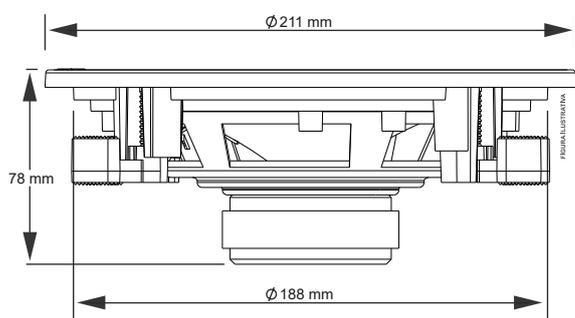
Para la instalación utilice la plantilla que viene con el producto. Perforación mínima Ø200mm
