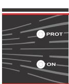
**ON:** Encendido indica que el amplificador está en funcionamiento.
