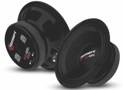
Desenvolvido para reproduzir com fidelidade médio graves e médio agudos o 8-MB-400S responde de 60 Hz à 4.000 Hz. Sua carcaça ventilada proporciona eficaz troca de calor preservando a bobina, com potência de 200 watts RMS o 8-MB-400S pode ser utilizado em diversos sistemas de som.
