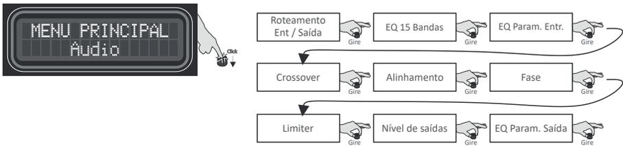
**-Roteamento ent / saída:** Define as conexões internas entre as saídas e as entradas. Opções disponíveis: A, B ou A+B (soma das duas entradas).
