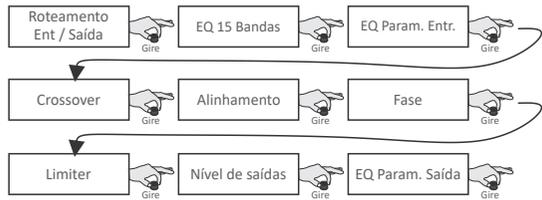
**-Roteamento ent / saída:** Define as conexões internas entre as saídas e as entradas. Opções disponíveis: A, B ou A+B (soma das duas entradas).
