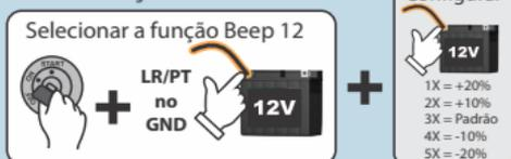
Para alterar, pulsar o fio LR/PT ao GND o número de vezes referente ao ajuste desejado. A cada pulso o alarme confirma com 1 beep. Após desligar a ignição, o alarme confirmará com beeps a nova configuração.
