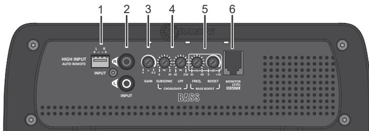
**1 - HIGH INPUT (FIO):** Entrada com dois canais, para sinais de alto nível / baixa impedância (da saída de alto falantes dos players ou central multimídia), com sistema de acionamento remoto automático compatível com multimídias originais com diagnose (A.S.S. Advanced Speaker Simulation OEM HU). Dispensa o uso do fio REMOTE IN do conector de alimentação quando se utiliza essa entrada.
