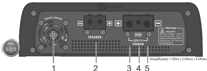
**1 - COOLER:** O BASS 1200 possui um cooler de ventilação interna e que não pode ser obstruído. Este cooler é controlado por um sistema inteligente (**Smart Cooler**). O mesmo só funciona em velocidade máxima a partir de um determinado nível de temperatura. Esta função garante maior vida útil do cooler e um funcionamento mais silencioso do seu amplificador.
