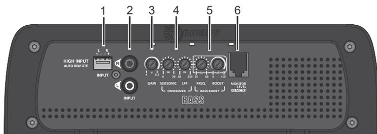
**1 - HIGH INPUT (Baja impedancia):** Entrada de cuatro canales, para señales de alto nivel/baja impedancia (desde la salida de altavoces de reproductores o centro multimedia), con sistema de activación remota automática compatible con multimedia original con diagnóstico (A.S.S. Advanced Speaker Simulator OEM HU). Elimina el uso del cable REMOTE IN del conector de alimentación cuando se utiliza esta entrada.
