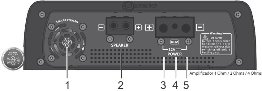
**1 - ENFRIADOR:** El BASS 1200 tiene un refrigerador de ventilación interno que no puede ser obstruido. Este enfriador está controlado por un sistema inteligente (**Smart Cooler**). Sólo funciona a máxima velocidad después de un cierto nivel de temperatura. Esta función garantiza una vida útil más prolongada y un funcionamiento más silencioso de su amplificador.
