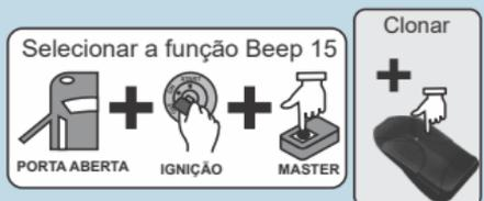
**Atenção:** Ligar o FIO MARROM ao sinal da chave de LUZ ALTA antes de clonar o controle, para a configuração automática do tipo de sinal POSITIVO ou NEGATIVO. Ao Clonar o controle original do Portão, automaticamente será alterada a configuração do fio marrom para Abrir/Fechar o Portão Automatizado.
