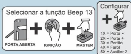
Para alterar, pressionar a chave Master o numero de vezes referente a função desejada. A cada pressionada na Master o alarme confirma com 1 beep. Após desligar a ignição, o alarme confirmará com beeps a nova configuração.
