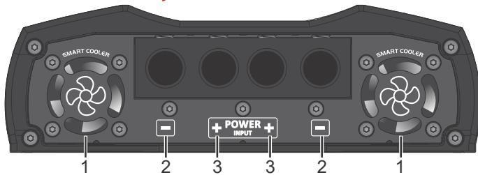
**1 - SMART COOLER:** Este amplificador tiene dos ventiladores de ventilación internos. Para un funcionamiento perfecto, el amplificador debe instalarse en un lugar fresco y aireado con un espacio mínimo de 1" (25 mm) de cada lado. La temperatura de trabajo habitual del amplificador es de 65°C.
