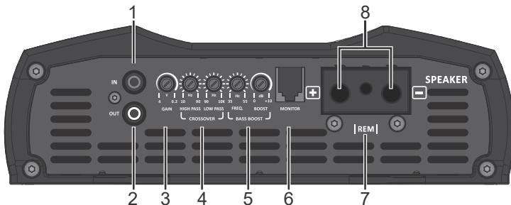
**1 - IN:** Entrada de la señal a ser amplificado. Conectar en la salida RCA del Rádio / Estéreo, utilizando cables blindados de buena calidad para evitar la captación de ruidos.
