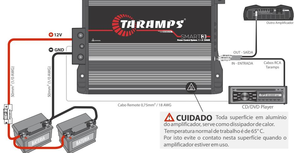
**CUIDADO** Toda superfície em alumínio do amplificador, serve como dissipador de calor. Temperatura normal de trabalho é de 65°C. Por isto evite o contato nesta superfície quando o amplificador estiver em uso.
