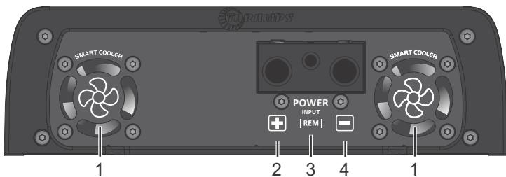
**1 - SMART COOLER:**Este amplificador tiene dos ventiladores de ventilación internos. Para un funcionamiento perfecto, el amplificador debe instalarse en un lugar fresco y aireado con un espacio mínimo de 1"(25 mm) de cada lado. La temperatura de trabajo habitual del amplificador es de 65 °C.
