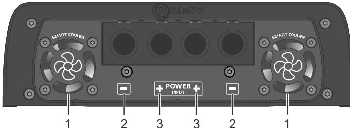
**1 - SMART COOLER:** Este amplificador tiene cuatro ventiladores de ventilación internos. Para un funcionamiento perfecto, el amplificador debe instalarse en un lugar fresco y aireado con un espacio mínimo de 1"(25 mm) de cada lado. La temperatura de trabajo habitual del amplificador es de 70°C.
