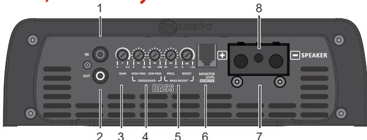
**1 - IN:** Entrada de la señal a ser amplificado. Conectar en la salida RCA del Rádio / Estéreo, utilizando cables blindados de buena calidad para evitar la captación de ruidos.
