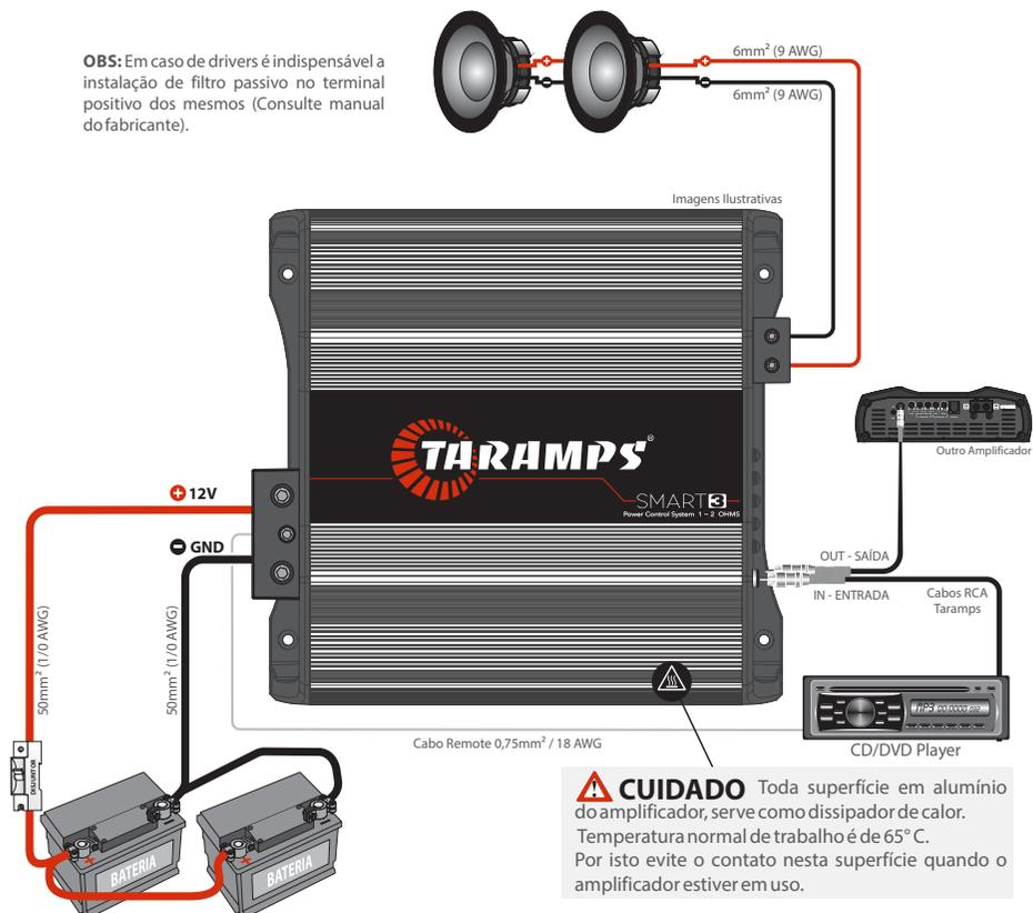
**⚠ CUIDADO** Toda superfície em alumínio do amplificador, serve como dissipador de calor. Temperatura normal de trabalho é de 65° C. Por isto evite o contato nesta superfície quando o amplificador estiver em uso.
