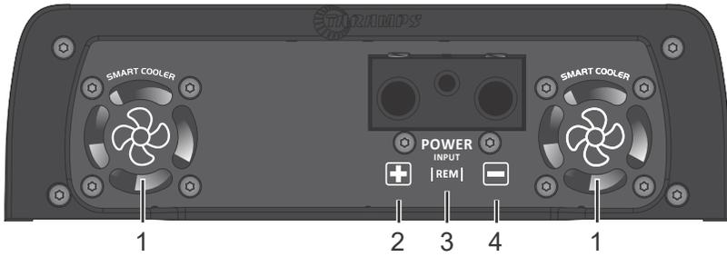
**1 - SMART COOLER:** Este amplificador possui dois coolers de ventilação interna, e que não podem ser obstruídos. Controlado por um sistema inteligente (Smart Cooler), o mesmo só funciona em velocidade máxima quando necessário, garantindo maior vida útil do cooler e um funcionamento mais silencioso do seu amplificador. Para perfeito funcionamento, o amplificador deve ser instalado em local seco e arejado. Recomendamos não embutir o mesmo, para garantir uma ventilação adequada.
