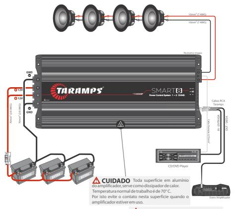
Exemplos de conexões na entrada de alimentação: Obs: Capacidade mínima requerida do banco de baterias: 400Ah
