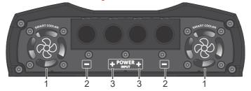
1 - **SMART COOLER:** Este amplificador possui quatro coolers de ventilação interna. Para perfeito funcionamento, o amplificador deve ser instalado em local seco e arejado, com espaço livre de no mínimo 1" (25mm) de cada lado. A temperatura normal de trabalho deste amplificador é de 70° C.
