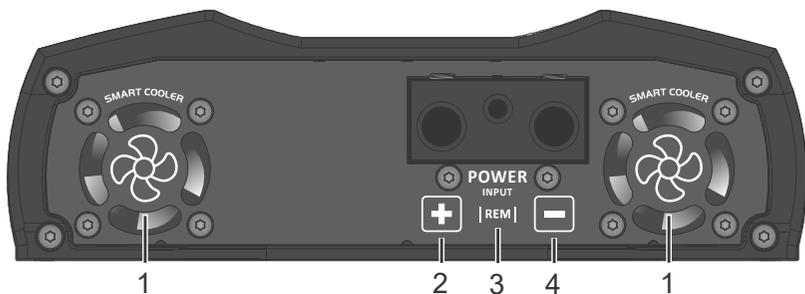
**1 - SMART COOLER:** Este amplificador possui dois coolers de ventilação interna, e que não podem ser obstruídos. Controlado por um sistema inteligente (Smart Cooler), o mesmo só funciona em velocidade máxima quando necessário, garantindo maior vida útil do cooler e um funcionamento mais silencioso do seu amplificador. Para perfeito funcionamento, o amplificador deve ser instalado em local seco e arejado. Recomendamos não embutir o mesmo, para garantir uma ventilação adequada.
