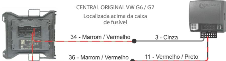
**Atenção:** A função abertura de porta malas somente funcionará em veículo com sistema elétrico original de abertura do porta malas. Para o perfeito funcionamento, aterrando corretamente o módulo do alarme. Algumas cores de fios poderão mudar sem prévio aviso da montadora. Necessário testar antes de fazer as ligações.
