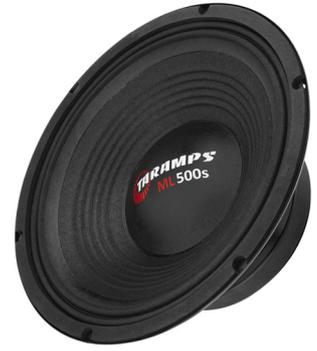
O modelo 10-ML 500S foi projetado para reproduzir com fidelidade graves e médio graves, respondendo de 55 Hz à 3.200 Hz. Sua carcaça ventilada proporciona eficaz troca de calor preservando a bobina, com potência de 250 watts RMS o 10-ML-500S pode ser utilizado em diversos sistemas de som.
