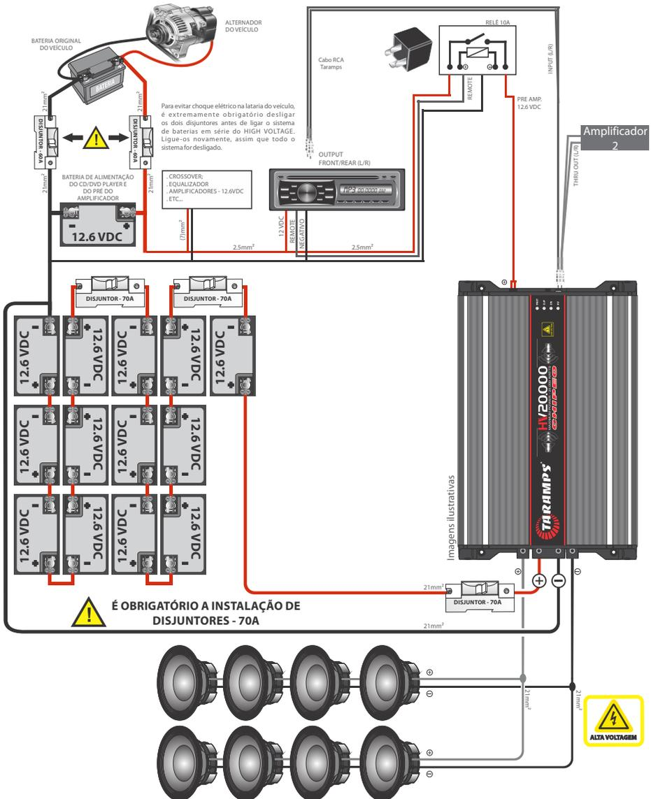
\*Bitolas dos cabos de saída de 21mm<sup>2</sup>, calculado considerando um comprimento máximo de 2m.
