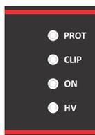
**LED VERDE (HV):** Indica presença de alta voltagem nos terminais de alimentação.
