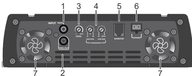
**1 - INPUT:** Conectar en la salida RCA del CD / DVD Player, utilizando cables blindados de buena calidad para evitar la captación de ruidos. Las señales de las entradas L y R se mezclan (agregan) internamente.
