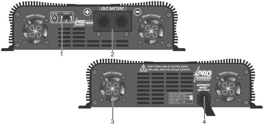
1 - **VOLTAGE / FINE ADJ.**: A tensão de saída pode ser selecionada em 12.6V , 13.8V ou 14.4V. Essa tensão pode ser ajustada em  $\pm 3\%$  através do recurso FINE ADJ, observando a tensão informada no display (VOLTÍMETRO).
