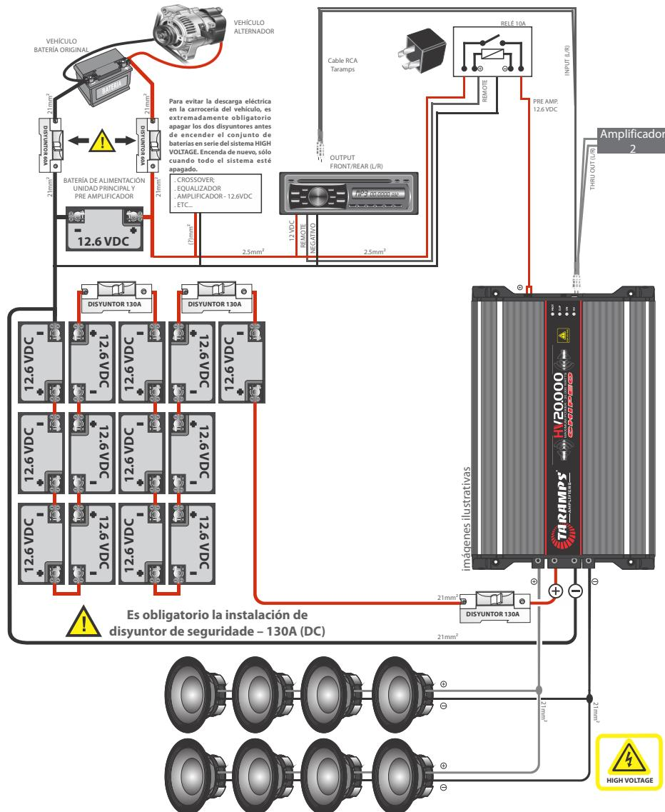
\* El calibre para el cable de salida es de 21 mm<sup>2</sup>, calculado considerando una longitud máxima de 2m.
