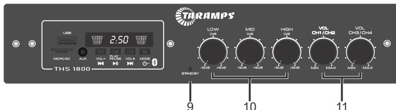
**9 - LED STAND BY:** Fica aceso quando o equipamento estiver desligado e conectado a tomada.
