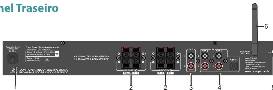
**1 - CABO DE ENERGIA:** Conecte o cabo na rede de energia elétrica. Este produto opera com alimentação de 127VAC ou 220VAC.
