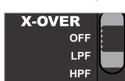
**LPF:** Filtros de frequência em modo passa baixa. Estes filtros permitem apenas a passagem de sons graves. Utilizar estes filtros caso conecte caixa acústica passiva de woofer ou subwoofer.
