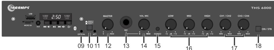
**9 - OPTICAL:** LED indicador de presença de sinal óptico. Indica que a entrada auxiliar atual é a óptica.
