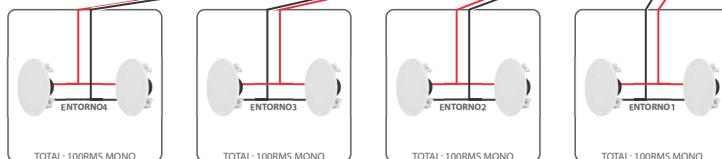
Para conectar los altavoces de techo, utilice cables con un calibre mínimo de 1,5 mm<sup>2</sup> (15 AWG) hasta 40 metros (131,2 ft). Para distancias más largas, consulte la tabla en la página 02 "Recomendaciones importantes". Es necesario realizar conexiones en paralelo y en serie como se muestra en el ejemplo, para igualar la impedancia.
