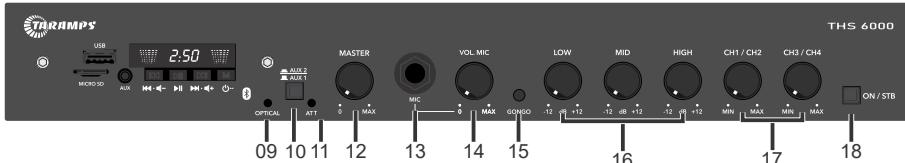
**9 - ÓPTICO:** LED que indica la presencia de una señal óptica. Indica que la entrada auxiliar actual es óptica.
