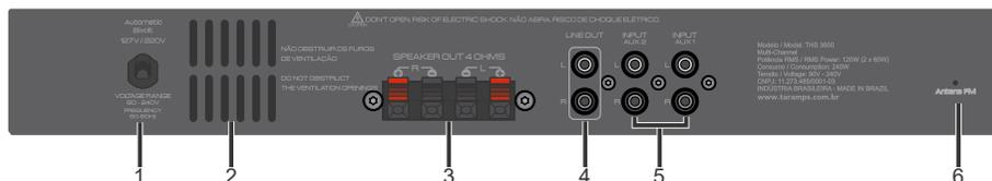
**1 - CABO DE ENERGIA:** Conecte o cabo na rede de energia elétrica. Este produto opera com alimentação de 90V AC à 240V AC 50Hz/60Hz.
