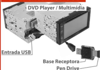
Para este tipo de instalação é necessário o uso de um cabo extensor USB, onde a base receptora do **Connect Control** é conectada neste cabo e que fique visível para o infravermelho do DVD player/Multimídia.
