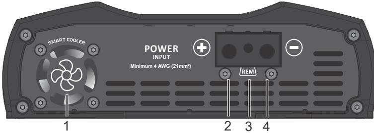
**1 - COOLER:** Este amplificador posee dos ventiladores de ventilación interna. Para un funcionamiento perfecto, el amplificador debe instalarse en un lugar seco y ventilado, con un espacio libre de al menos 1" (25mm) a cada lado. La temperatura de trabajo de este amplificador es de 65°C.
