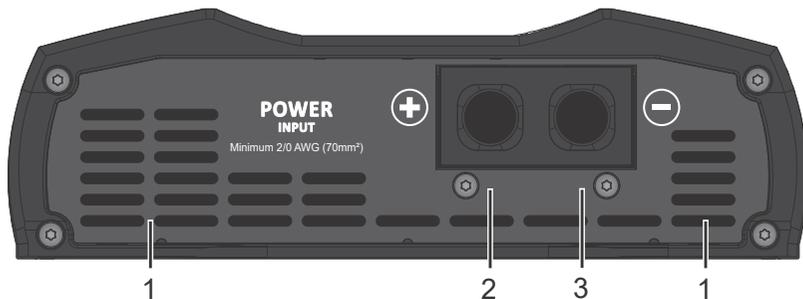
**1 - COOLERS:** Este amplificador possui dois cooler de ventilação interna. Para perfeito funcionamento, o amplificador deve ser instalado em local seco e arejado, com espaço livre de no mínimo 1" (25mm) de cada lado. A temperatura normal de trabalho deste amplificador é de 65° C.
