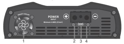
1 - COOLER: Este amplificador possui um cooler de ventilação interna. Para perfeito funcionamento, o amplificador deve ser instalado em local seco e arejado, com espaço livre de no mínimo 1" (25mm) de cada lado. A temperatura normal de trabalho deste amplificador é de 65°C.
