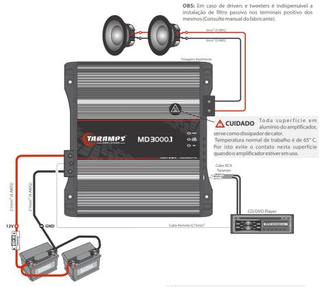
Exemplos de conexões na entrada de alimentação: Obs: Capacidade mínima requerida do banco de baterias: 150A
