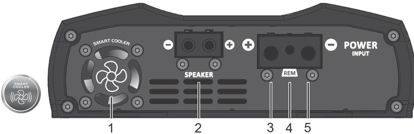
**1 - COOLER:** Este amplificador possui um cooler de ventilação interna. Para perfeito funcionamento, o amplificador deve ser instalado em local seco e arejado, com espaço livre de no mínimo 1" (25mm) de cada lado. A temperatura normal de trabalho deste amplificador é de 65°C.
